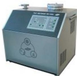
Откачной пост представляет собой систему последовательно соединенных турбомолекулярного и форвакуумного насосов, вакуумной арматуры, вакуумных клапанов, приборов контроля давления.
